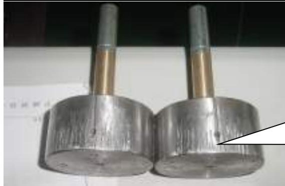
如果柱塞磨损在 0.6mm 内, 表面不光滑时, 可以用砂皮(粒度:100)粗磨, 然后再用金相砂纸修光
